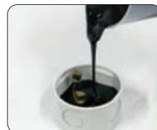
Verter el producto en el envolvente que se desea rellenar.
