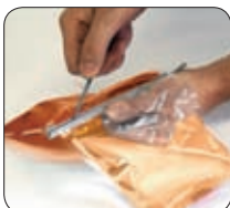
Retirar el separador de la bolsa de Rayresin.
