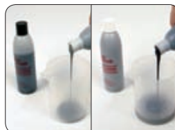
Verter los dos componentes en relación 1:1.
