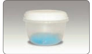
el gel sobrante ya reticulado puede ser fácilmente eliminado del medidor y conservado para un uso futuro.
