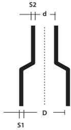
D = Ø diamètre minimal avant le rétrécissement
