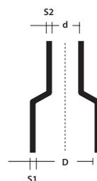
**D** = Ø diamètre minimal avant le rétrécissement
