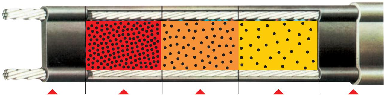
Les particules de graphite constituent autant de connexions en parallèle entre les deux conducteurs en cuivre.
