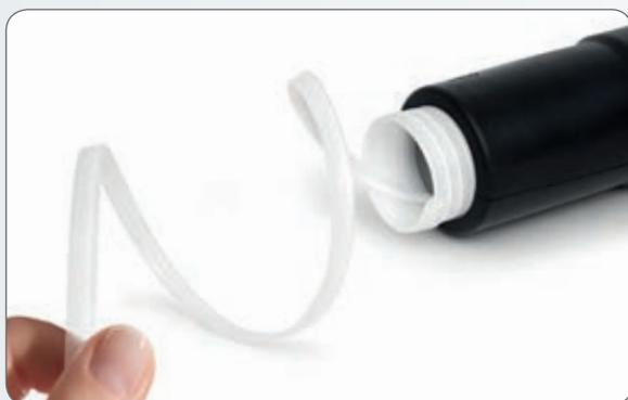
La forme particulière et le profil de la section de support permettent la dilatation sûre du corps de la jonction, en évitant des stress nuisibles pour la durée en stockage mais surtout une extraction en douceur, facilitée, sans déchirures ni sollicitations dangereuses durant l'installation de la jonction.
