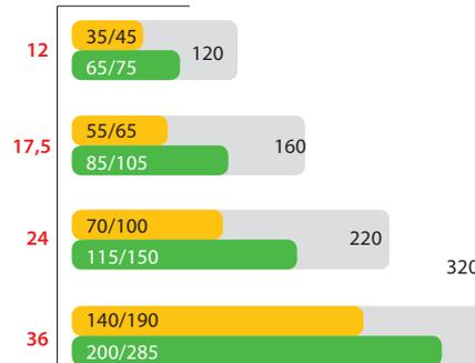
Espacement dans l'air selon IEC 71-2 phase / phase (mm), phase / terre (mm)
