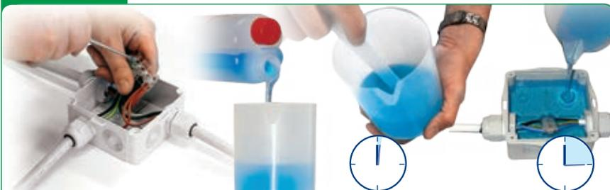
Il est possible d'utiliser l'isolant Magic Power fourni dans la bouteille bi-composant, en proportion 1:1, simplement en le versant, une fois mélangé, dans le boîtier fourni dans le kit, afin de protéger et de sceller les connexions à l'intérieur. Le gel nécessite seulement 15 min environ pour réticuler, mais le boîtier peut être immédiatement alimenté.
