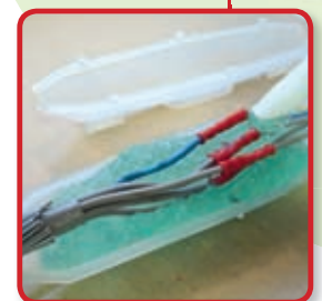
AANSLUITINGEN ONDER WATER
