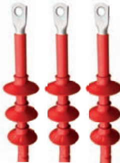
Eenpolige terminals voor buiten Voor geëxtrudeerde kabels tot 36 kV
