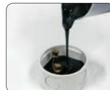
Het product gieten in de te vullen omhulling.
