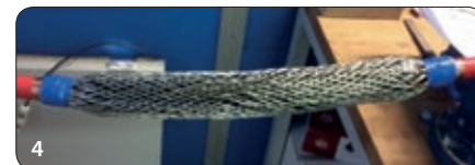
4 O escudo de metal é reconstruído
