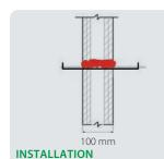
Nach der Reinigung der Ränder der Öffnung wird die Dose für mindestens 30 Sekunden geschüttelt, dann umgekippt und endlich wird das Produkt gespritzt.
