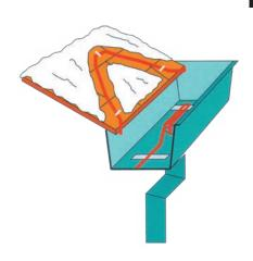
Nel disegno viene mostrato il tracciamento della grondaia, l'ingresso del cavo nel pluviale e il tracciamento della falda del tetto.
