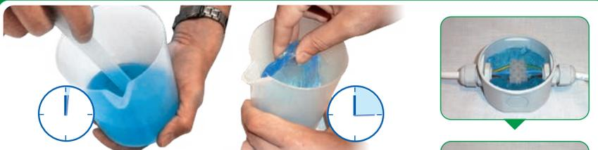
Colare i componenti nel misurino, miscelare e lasciare reticolare (circa 15 minuti). Togliere l'isolante, e posizionarlo in piccole parti attorno alla connessione in modo che ne sia completamente ricoperta. Naturalmente può utilizzarsi l'isolante conservato da precedenti miscele.
