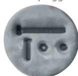
Bereiding ter plaatse van kleine mallen voor afdrukken
